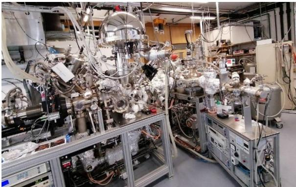
Figure 3 : photographie (F. Chassot) du laboratoire de photoémission, avec, au centre, l'hémisphère de l'analyseur d'électron pour la spectroscopie de photoémission.
